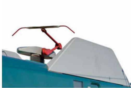
Der neugestaltete besonders leise Pantograph.
