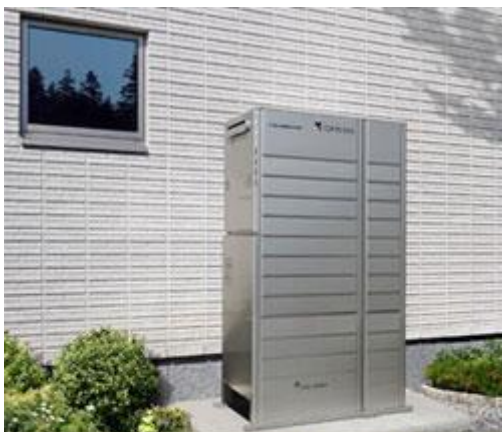
Das Enefarm-System erzeugt Strom mittels einer Wasserstoff-Sauerstoff-Reaktion. Die als Nebenprodukt anfallende Wärme wird für die Heißwasserversorgung und für die Fußbodenheizung genutzt. © Tokyo Gas Co., Ltd.
