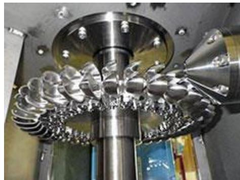
Links: Experimentelle Anlage eines *yukemuri* Dampfgenerators, bei dem Strom durch den Antrieb einer Turbine mit heißem Wasser und Dampf aus Thermalquellen erzeugt wird. ©TurboBlade
