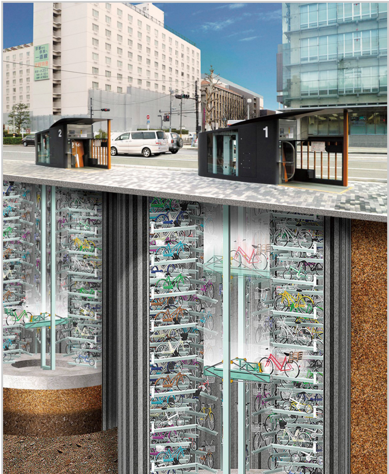
Bild: Hightech-Parksysteme für Fahrräder in Kyoto können jeweils rund 200 Fahrräder aufnehmen. (Foto: Giken Ltd.)
