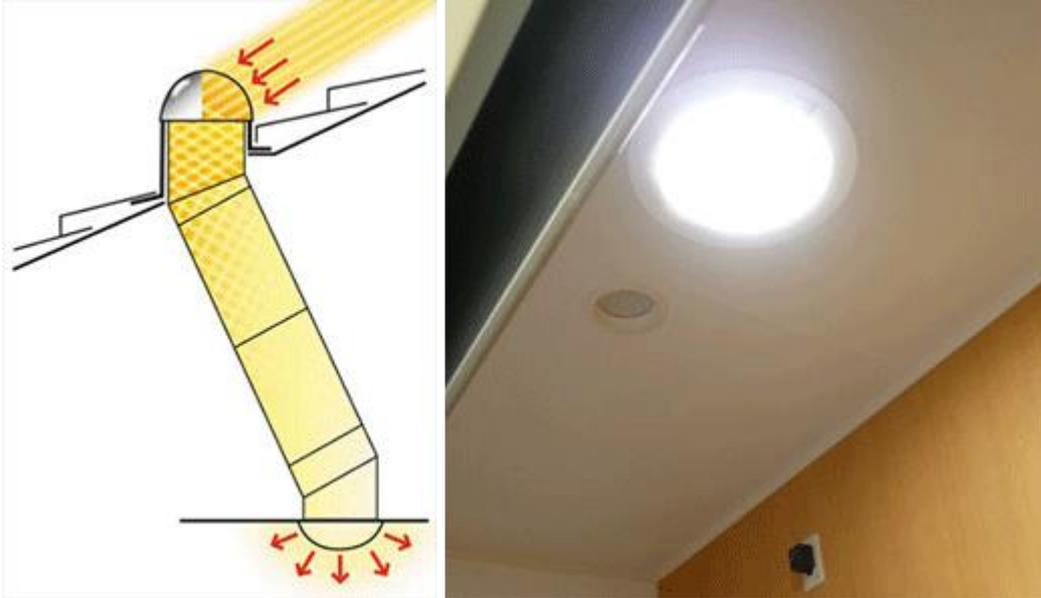
Links: Die Lichtkanäle fangen das Sonnenlicht über eine transparente Kuppel ein, die auf dem Dach installiert ist, und lenken es von dort über eine spezielle Röhre direkt in den Laden. Das Röhreninnere ist so verarbeitet, dass fast einhundert Prozent des Sonnenlichts reflektiert werden.
