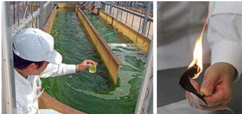
Links: Empirische Experimente in einem 350 m 2 Zuchtank (Foto: DENSO Corp.). Rechts: „Enomoto Algen“ – eine verbesserte Züchtung von Botryococcus werden getrocknet und entzündet. (Foto: IHI NeoG Algae LLC)
