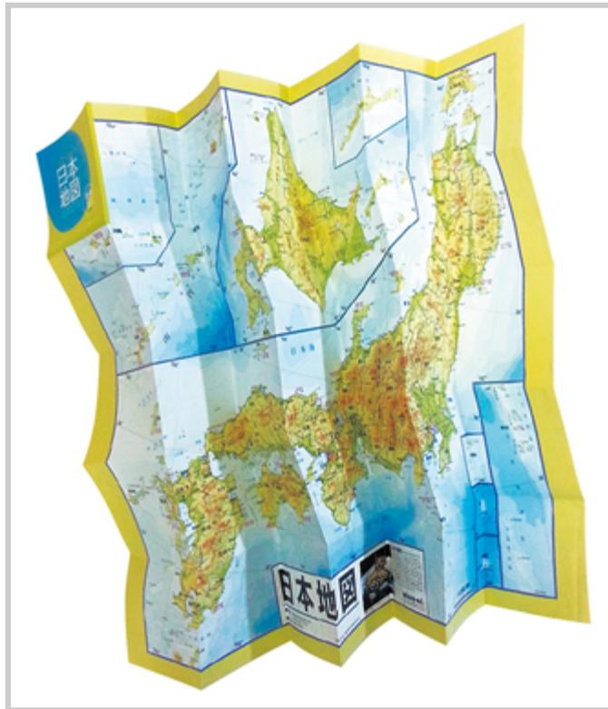
**Bild:** Bei Landkarten und Stadtplänen wird die miura-ori Faltechnik verwendet. Für das Zusammenfallen wird die Karte an der oberen linken und unteren rechten Ecke gehalten und dann zusammengeschoben. Das Entfallen erfolgt blitzschnell. (Foto: miura-ori-lab)
