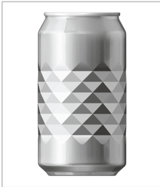
**Bild:** Eine Getränkedose mit „Diamantschliff“ in miura-ori Faltechnik. Die aneinandergereihten Dreiecke machen die Dose stabiler als herkömmliche Dosen; zugleich ist sie aber leichter. (Foto: Toyo Seikan Co., Ltd.)
