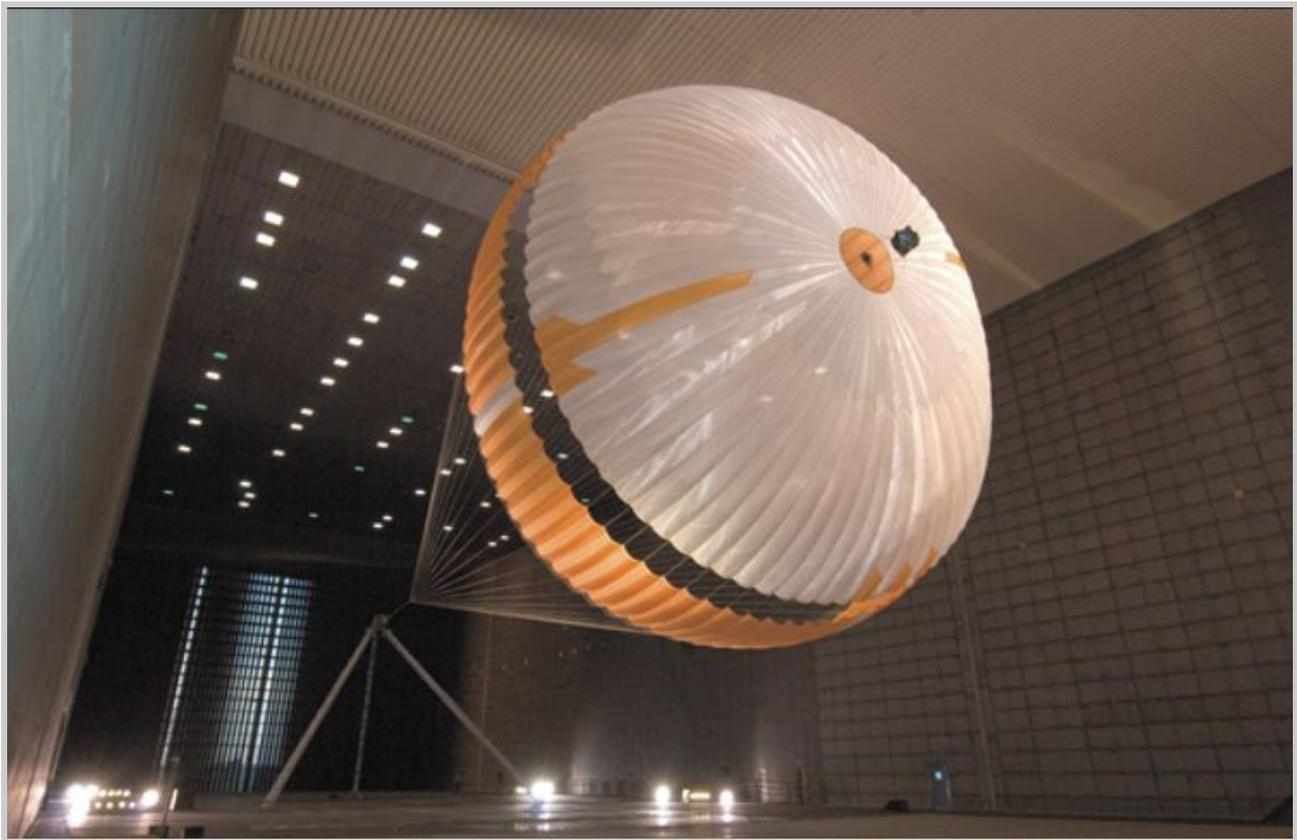
***Bild:** Der Landeschirm der Raumsonde Curiosity entfaltet sich während eines Tests im Windkanal. Die Leinen, die Schirm und Sonde miteinander verbinden, bestehen aus einer Aramidfaser namens Technora, die vom Unternehmen Teijin Ltd. entwickelt wurde. (Foto mit freundlicher Unterstützung von NASA/JPL-Caltech)*
