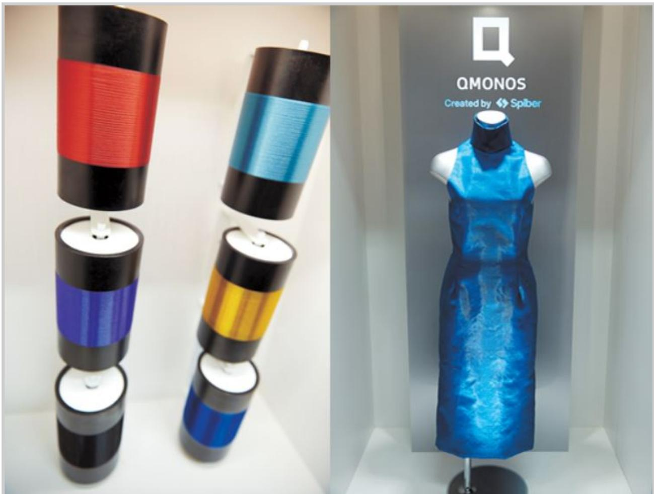
***Bild:** Farbiges Garn von QMONOS, eine aus Protein hergestellte Faser, die an Spinnenseide erinnert, sowie ein aus Stoff von QMONOS gefertigtes Kleid. (Foto mit freundlicher Unterstützung von Spiber Inc.)*
