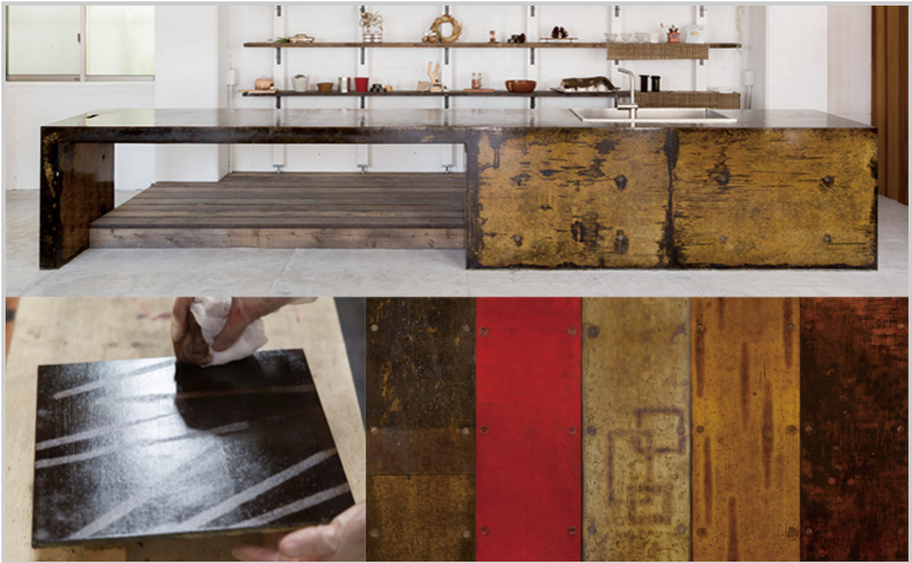
Bild: Eine Küchenzeile aus Beton mit einem Überzug aus urushi. Der Lack kann direkt auf die Oberflächen der feuerfesten Materialien aufgetragen werden. Die mit urushi überzogenen Flächen erhalten dadurch eine schöne organische Textur. (Mit freundlicher Unterstützung von Heisei Corporation)
