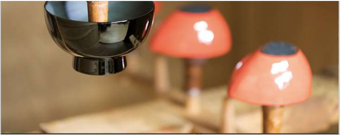
Bild: 7. Da der Lack beim Aushärten Feuchtigkeit aufnimmt, erfolgt die Trocknung in einem Raum, in dem Luftfeuchtigkeit und Temperatur genau kontrolliert werden.
